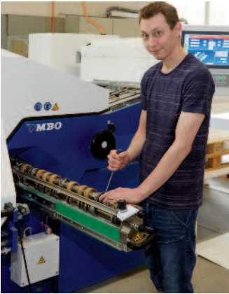
Auf der K80 kann Remo Besserer die Messerwelle auf einem Schlitten seitlich herausziehen.
