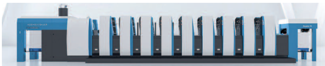
Rapida 76-8+L ALV2 mit insgesamt 9 High-Tech-Werken (acht Druckwerke und ein Lackwerk).
