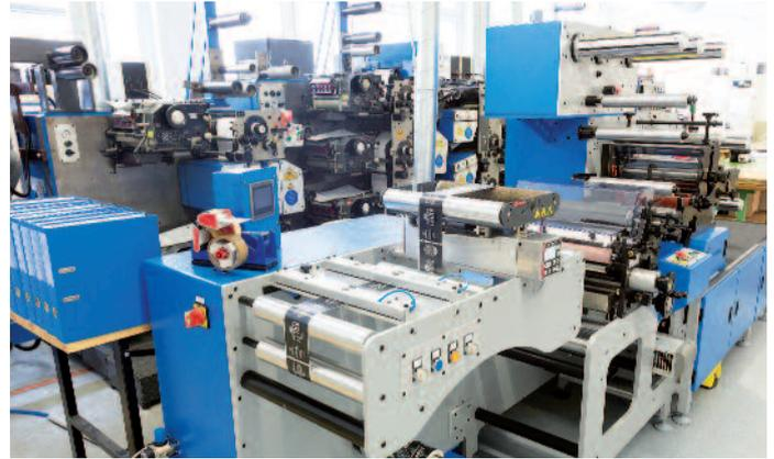
den. Hinter der Finishingmaschine mit Stanzfunktion ist die Gallus R 200 B erkennbar, eine Zehnfarbenmaschine mit Inline-Verarbeitungsfunktionen.
