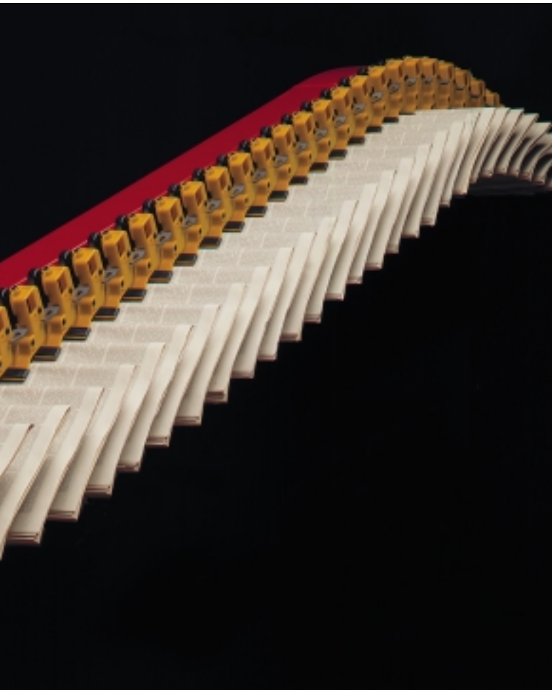
Die Basis-Erfindung des schmierfreien Transports von Zeitungsexemplaren von der Rotation zum Versandraum ist bis heute Kern der Ferag-Technologie. Das reine Transportieren von Produkten zur verarbeitenden Fördertechnik, um die Bedürfnisse moderner Verlage zu erfüllen.
