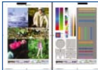
**Auf der Vorderseite (links) der A4-Musterdrucke geben ausgewählte Bilder Aufschluss über die Druckqualität bezüglich Hauttönen, Farbbalance, Tiefenzeichnung etc. Die technischen Sujets auf der Rückseite stellen besondere Herausforderungen bezüglich Druckauflösung, Passergenauigkeit und Farbtreue.**
