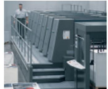
Die Bogenoffsetmaschine steht für eine Geschwindigkeit von 18.000 Bogen pro Stunden, großes Druckformat und hohe Qualität.
