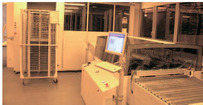
Vogt-Schild's Lüscher XPose UV 230 mit Deloader und dem Platten Handling-System PHS 230 mit fünf Kassetten. In der rechten Abbildung der NELA-Teil der Installation: Rechts die Einlaufstrecke von der Entwicklungsmaschine in
