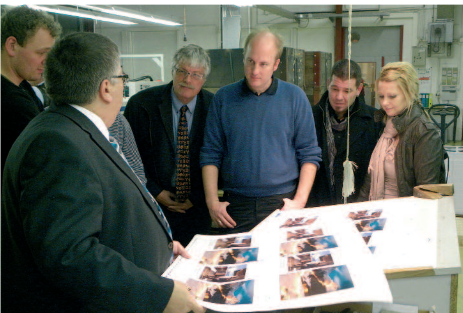
Die Kontrolle der veredelten Bogen unter einem speziellen Licht.
