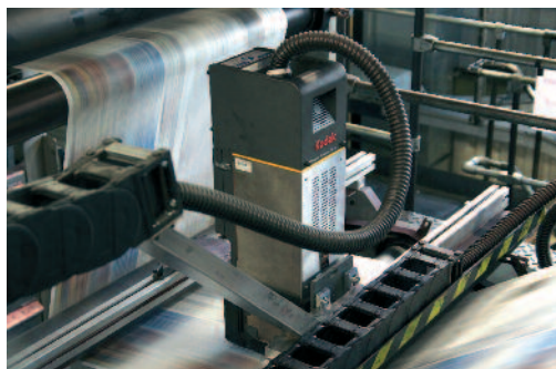
Erhebliche Fortschritte erzielte Kodak bei den Eindrucks-köpfen. Mit dem Prosper-S30-Kopf werden bei Axel Springer in Ahrensburg in einer Rotation Geschwindigkeiten von 13,2 m/Sek. erreicht.
