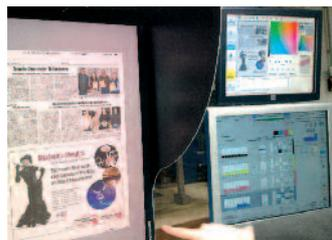
Beispiel einer KBA Zeitungsrotation mit Softproof. Die spezielle Blende im Normlichtbereich reduziert Reflexionen auf dem Monitor. Oben die Detailabbildung.
