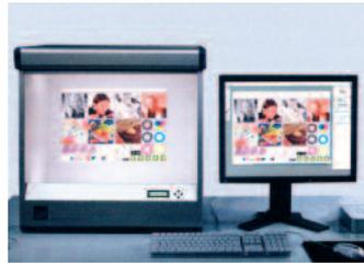
Kalibrierte Bildschirme in unterschiedlicher Umgebung beim Fotografen (links) und ein typischer Prepress-Arbeitsplatz mit zum Monitor abgestimmter Lichtbox in Normumgebung. (Bildquelle: BVDM PSO Kapitel Softproof).
