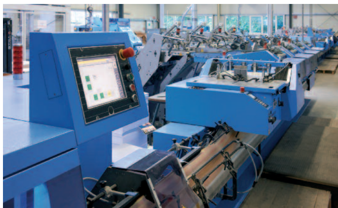
Die Sammelhefter Primera von Alpa GmbH in Geldern und Imprimerie Leclerc in Abbeville sind an das Daten- und Prozess-Management-System Connex von Müller Martini angeschlossen.
