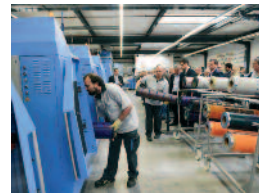
Die Open-House-Besucher konnten sich ein Bild davon machen, wie schnell die Druckformate bei der stufenlos formatvariablen VSOP 850 dank der Sleeve-Technologie ausgewechselt werden können.
