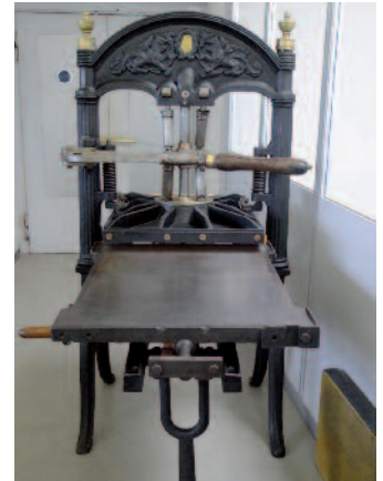
Kniehebelpresse, Baujahr um 1780, von Christian Dingler.
