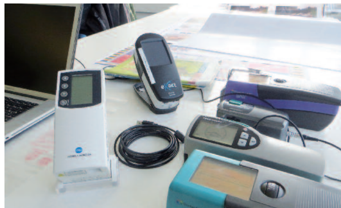
Für eine messtechnisch verlässliche Bewertung auf Papieren mit OBA sind Messgeräte notwendig, die es erlauben, nach dem M1-Messmodus zu messen. Seit 2012 sind alle neuen Messgeräte entsprechend ausgerüstet.
