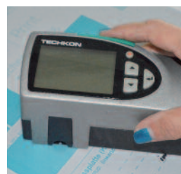
Zur Kontrolle wird täglich eine mit Kontrollelementen belichtete und verarbeitete Libra VP Platte vermessen.
