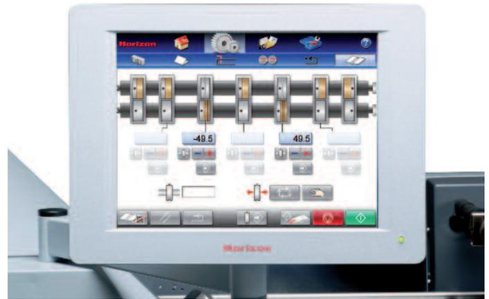
Der Score-Navigator ermöglicht die präzise Positionierung der Rillwerkzeuge mit nur einem Knopfdruck.
