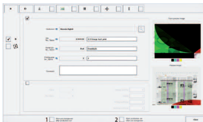
Mit zwei Klicks am ErgoTronic-Leitstand ist das autonome Drucken aktiviert: 1. Auftragswechsel startet nach Fortdruck. 2. Fortdruck startet nach Auftragswechsel.
