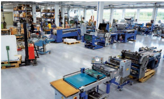
Für die Herstellung einfacher und anspruchsvoller Falzprodukte schöpft die Schär Druckverarbeitung aus einem immensen Reichtum an MBO-Falzwerken, die sie bedarfsgerecht zu Falzmaschinen zusammenstellt.
