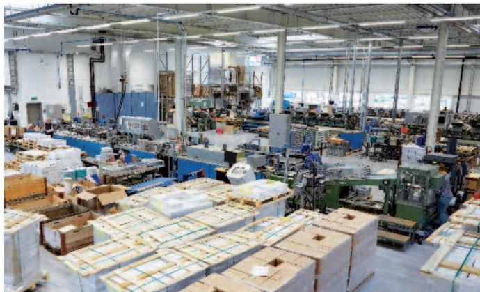
In der Versandabteilung dominieren Kuvertier- und Verpackungslinien von CMC. Eine Read-and-Print-Funktion erlaubt es, für Druck-Erzeugnisse mit personalisiertem Inhalt die Kuverts und Verpackungsfolien inline zu adressieren.
