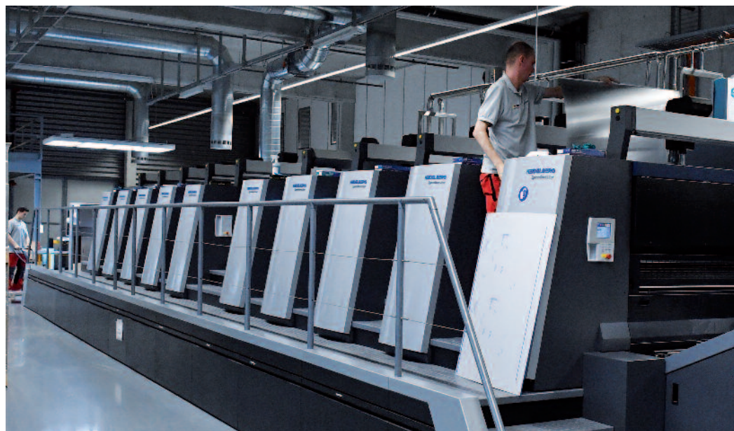
Ursprünglich sollte eine zehn Jahre alte Fünffarbenmaschine ersetzt werden. Stattdessen wurden bei der Merkur Druck AG zwei Maschinen gegen eine Zehnfarben-Speedmaster mit LED-UV-Ausstattung ausgetauscht.
