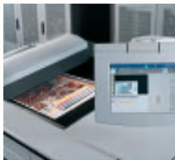
Das hochgeklappte Inline-Farbmessgerät Prinect Inpress Control in einer SM CD 74. Links Prinect Image Control, die High-End-Lösung für die Farbregelung von bis zu vier Druckmaschinen.
