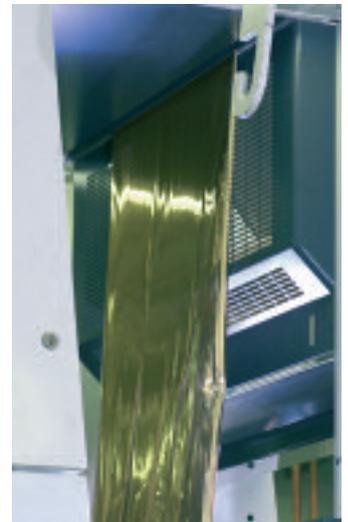
Für den Folientransfer werden zwei Druckwerke benötigt: das erste überträgt Kleber auf den Bedruckstoff, im zweiten Druckwerk wird die Folie auf den Bedruckstoff übertragen und die Trägerschicht wieder aufgerollt.
