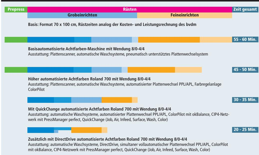
Vergleich der Rüstzeiten von Achtfarben-Bogenoffsetmaschinen im Format 70 x 100 cm und im 4-über-4-Druck. Basis für die Berechnungen sind die Kosten- und Leistungsrichtlinien des Bundesverband Druck und Medien bvdM, wobei die Referenzmaschine mit Plattenscanner, automatischen Waschsyste- men und pneumatischen Plattenwechselsyste- men ausgestattet ist.
