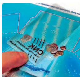
Mit Decodierlinsen wird in der Verpackung ein verdecktes Bild erkennbar. Interessiert verfolgen die
