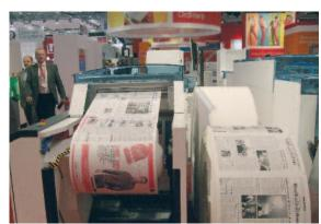
Lotterien bis hin zum 1:1-Marketing, da variable Daten auf jeder Seite und an fast jeder beliebigen Stelle der Zeitung inline aufgebracht werden können. Gedruckt werden soll bei Maschinenvolllast und einer Bahngeschwindigkeit von 15 m/s. Die Kosten von lediglich 0,05 bis 0,2 Eurocent pro Eindruck könnten das Verfahren also durchaus attraktiv machen. Selbst bei großen Zeitungsauflagen.
