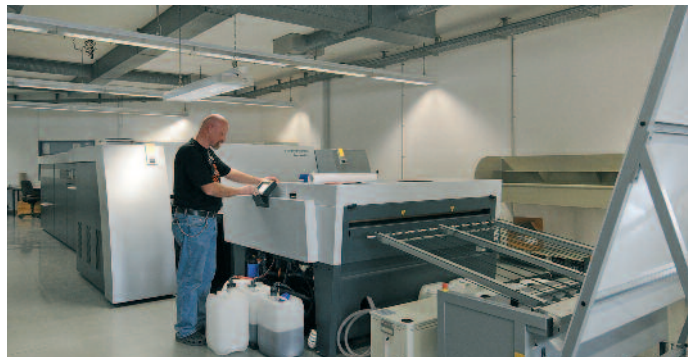
Die Versorgung der zwei neuen Druckmaschinen mit Druckplatten ist über einen Großformatbelichter Suprasetter 145 gesichert.
