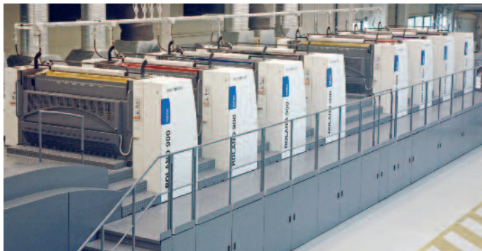
Mehr als zwei Millionen Druckbogen sind schon gedruckt. Wenige Wochen nach Inbetriebnahme der Roland 900 XXL zieht die Augsburger Druckerei Himmer großen Nutzen aus ihrer weltweit ersten Bogenmaschine im Format 8 mit Wendung.
