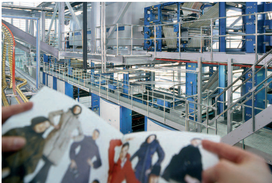
Zeitungen im Coldset-, Magazine im Heatset- und Mischprodukte im Coldset-/Heatset-Druck ohne Farbwechsel sind eine Stärke der KBA Cortina (hier ein Foto der Maschine im Eco Print Center des belgischen Medienhauses De Persgroep).
