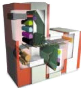
Die Xeikon CPS 320 D bebildert das Papier von einem Band statt bisher von einer Trommel. Der schlanke Bogendurchlauf erlaubt das Bedrucken stärkerer Papiere.
