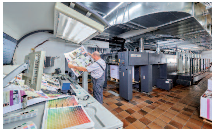
Auf der Fünffarben-Bogenoffsetdruckmaschine mit zusätzlichem Lackwerk produziert cre art mit der prozessfreien Kodak Sonora UV Platte im LEC-UV-Verfahren.
