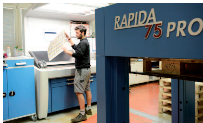
Für Christoph Paver hat sich die Druckproduktion an der Rapida 75 Pro dank der weitgehenden Automatisierung deutlich erleichtert. Die Rapida 75 Pro verfügt über einen ErgoTronic-Leitstand mit TouchTronic-Bedienung und Wallscreen.
