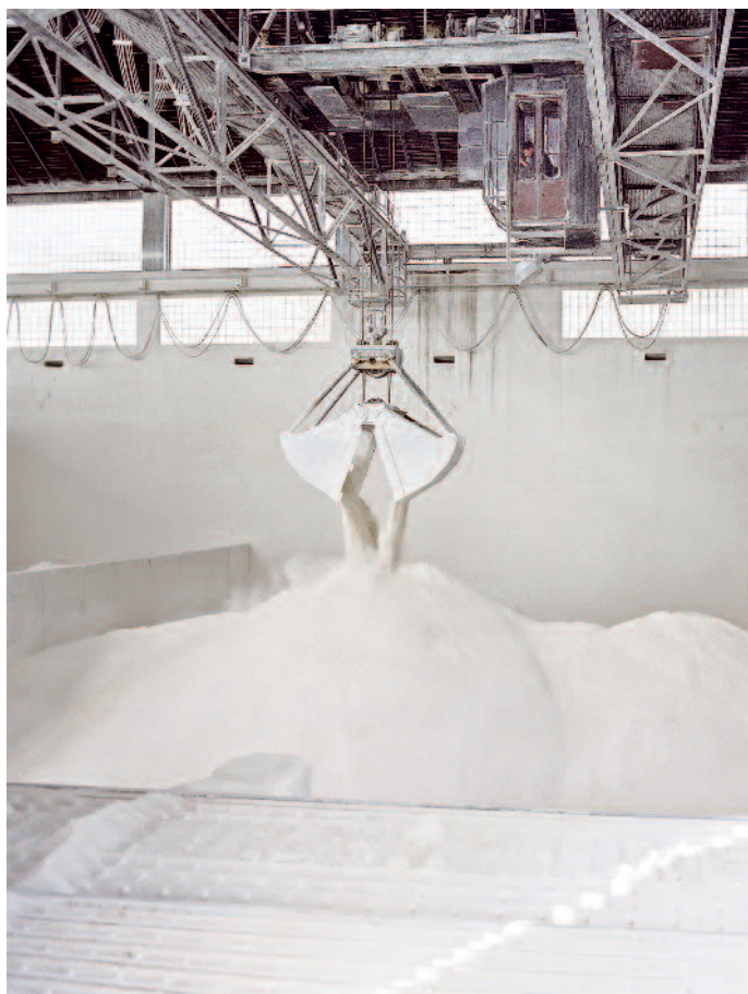
Pigmente dienen bei der Papierproduktion als Füllstoffe, um die Weiße und Opazität zu erhöhen und das Papier dichter zu machen. Kaolin beispielsweise (weiße Tonerde, siehe Bild) wird zu einer Suspension aus Wasser und Chemikalien aufbereitet und gelangt auf die Streichmaschine (Foto: Scheufelen).
