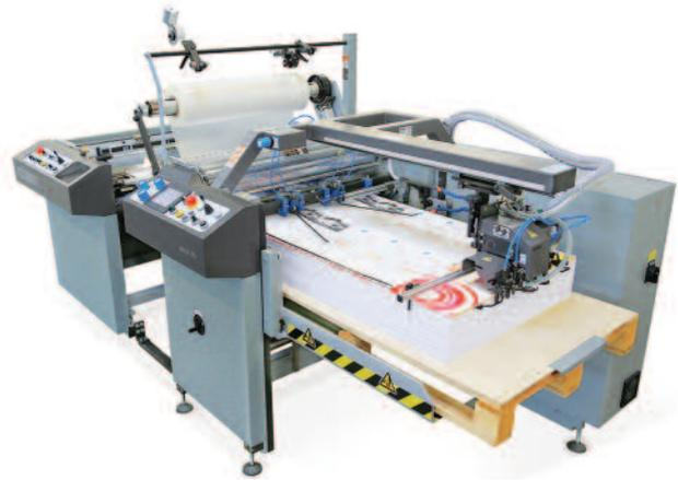
FKS Komfi Delta 76: Ein Hochleistungssystem für Formate bis 760 x 1.020 mm und Leistungen bis 35 m/Min.
