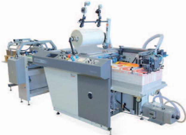
FKS Komfi Sagitta 52: Ein Hochleistungssystem für Formate bis 520 x 760 mm und Leistungen bis 50 m/Min.
