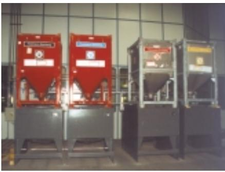
**Vorratshaltung:** Das Betz Farbversorgungssystem ColorPro an der neuen MAN Lithoman IV bei Roto Stalling beginnt bei der Bevorratung der LWC- und B-Stoff-Druckfarben in 1500 kg Basiscontainern, auf die als Huckepack-Lösung 1000 kg Wechselcontainer aufgesetzt werden.
