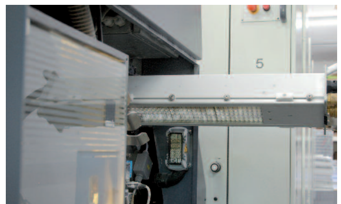
Das LEDcure-System von IST Metz wurde im Bogenausgang der Fünffarben-Druckmaschine Roland 305 integriert.
