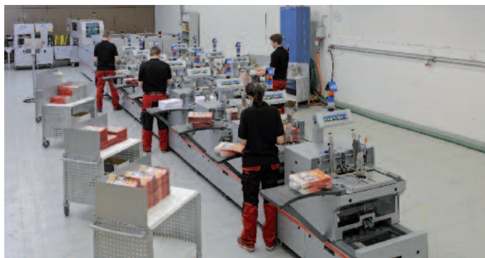
Das one2out-System besteht aus zwei Strängen mit maximal 21 Anlegern pro Strang. Hier eine Anlage, die bei Ferag in Hinwil, Schweiz, aufgebaut ist.
