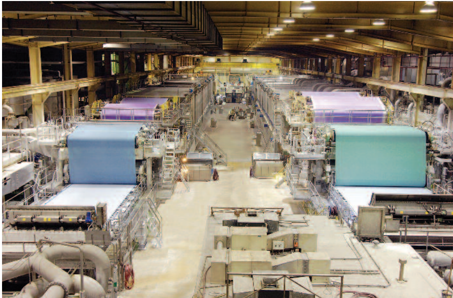
Crown Van Gelder ist mit etwa 250 Mitarbeitern im niederländischen Velsen eine relativ bescheidene Papierfabrik mit zwei Papiermaschinen in 3,6 Meter beziehungsweise 4,8 Meter Breite und einer Kapazität von rund 180.000 Jahrestonnen.
