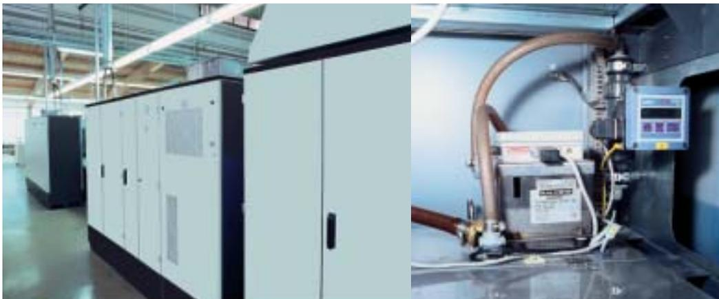
Die CombiLiner von Baldwin vereinen mehrere Funktionen in einem kompakten Systemgehäuse: Die Temperierung des Farbreiberkühlwassers, die gezielte Abfuhr der Abwärme und die Aufbereitung, Kühlung und Temperierung des Feuchtmittels für den Offsetdruck. Außerdem kommt die Funktion der exakten Messung und Dosierung
