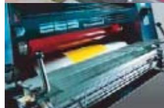
flüssigkeit benötigt. Die inmarque Watermark Unit wird an der Druckmaschine an Stelle des Nummerierwerkes montiert und angetrieben. Als Druckform dient ein übliches Nylonprint-Klischee.
