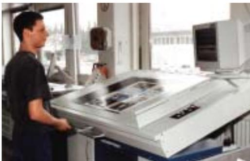
Mit Densitronic S erfolgt die Qualitätskontrolle und -regelung direkt an der Druckmaschine.
