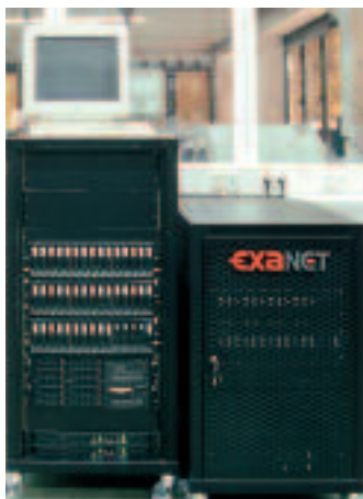
Alles, was ExaStore an Hardware benötigt, hat bis zu einer Speicherkapazität von 9 Terabyte in dem linken Schrank Platz.
