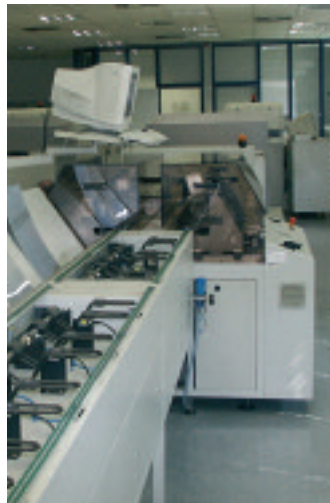
Die Abkant- und Sortiereinheiten von Nela bilden den Abschluss der beiden Newsletter-Linien.
