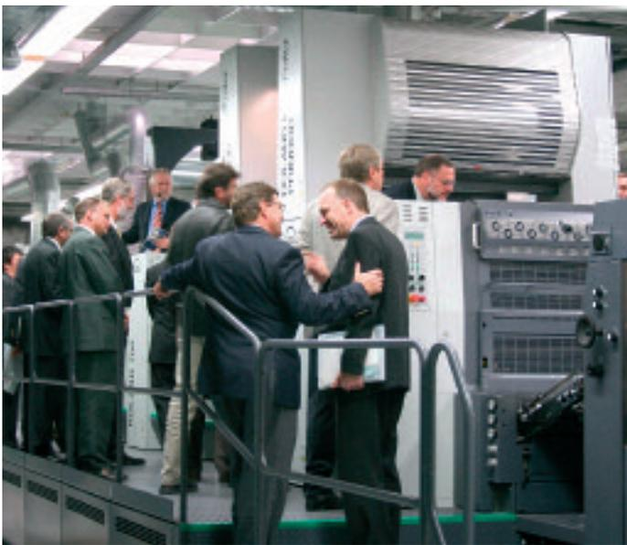
Druckmaschinen gehen nicht nur in die Länge, sondern wie hier bei MAN Roland auch in die Höhe. Der Inline-Foiler lässt Veredelungen innerhalb der Maschine zu und erpart vor allem den Verpackungsdruckern und Veredlern die externe Verarbeitung.
