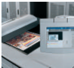
Das hochgeklappte Inline-Farbmessgerät Prinect Inpress Control in einer SM CD 74. Links Prinect Image Control, die High-End-Lösung für die Farbregelung von bis zu vier Druckmaschinen.
