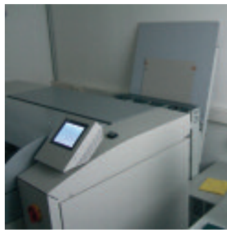
CtP auf kleinstem Raum: Der Fujifilm Luxel T-6000 CTP E wird mit dem Fujifilm Celebrant-Workflow angesteuert und benötigt durch Einsatz der prozesslosen PRO-T keine Entwicklungsmaschine.
