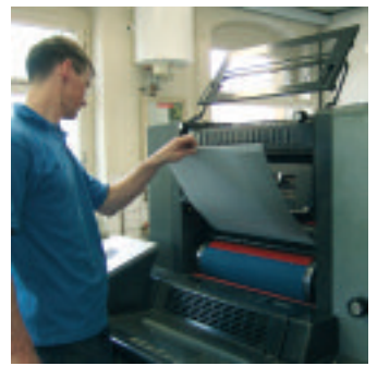
Der Reiz der prozesslosen Platte liegt in der einfachen Handhabung. Belichten, einspannen und drucken. Dazu bescheinigen die Drucker der Platte sehr gute Druckeigenschaften und eine hohe Stabilität.
