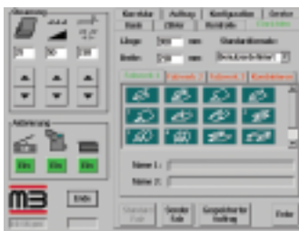
Auswahl der Falzarten über Touch-Screen an der prestigeFOLD NET 52.
