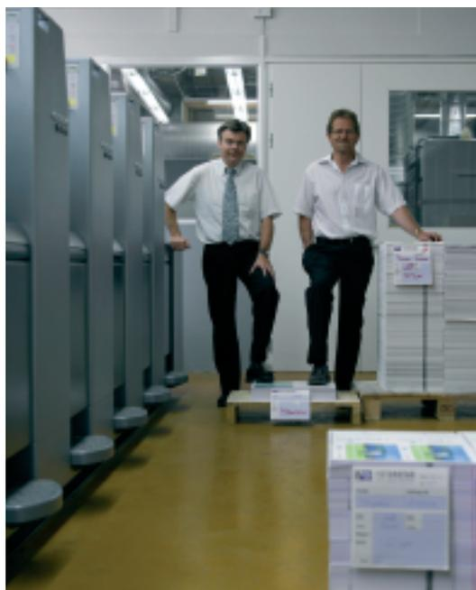
Die Speedmaster SM 52-Fünffarben plus Lack mit Kurzfarbwerk Anicolor wird bei Fotorotar getestet. Otto Brunner (rechts) und Jürg Konrad, die beiden Geschäftsführer von Fotorotar, ziehen eine positive Bilanz der bisherigen Testphase mit der Fünffarben-Anicolor-Maschine: »Bei Auflagen von weniger als 1.000 Exemplaren sinken durch Anicolor die Druckkosten um rund 30 Prozent.«
