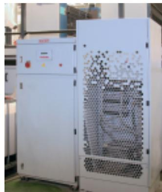
Ebenso unscheinbar wie unverzichtbar: Die Baldwin Performance Filtration übernimmt die Feinfiltration des Feuchtmittels für den alkoholfreien Druck. Der Baldwin Viskomat (rechts) bringt den allgegenwärtigen Dispersionslack in konstante Verfassung.
