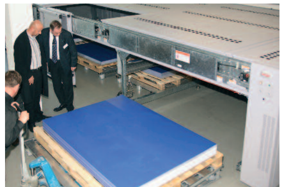
Während des Open-Houses bei Himmer gewährte Kodak den Besuchern tiefe Einblicke in die Anatomie des neuen automatischen Palettenladers. Demonstration mit Druckplatten im Format 1.380 x 1.860 mm: die Platten werden auf der Palette per Hubwagen in den Palettenlader eingeführt.
