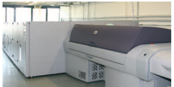
Der automatische Palettenlader versorgt den Kodak Magnus VLF Quantum Plattenbelichter von links mit Druckplatten.
