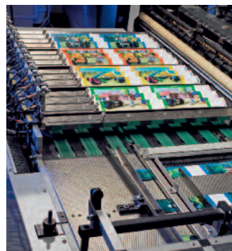
Spezielle Weiterverarbeitungsmaschinen ermöglichen das Herstellen von Kartensets in der richtigen Reihenfolge. Teil der Weiterverarbeitung ist die Sortiermaschine.
