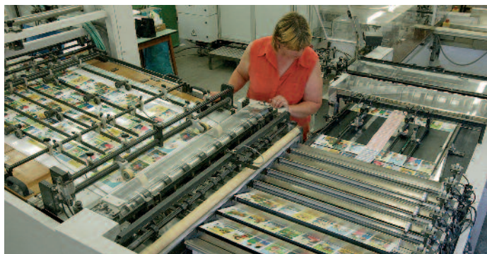
Wenn der Druckbogen zum Kartenspiel werden soll, werden ganz spezielle und automatische Verarbeitungsmaschinen eingesetzt. Die Bögen werden auf Kartenschneidemaschinen nahezu automatisch zu Spielkarten verarbeitet.
