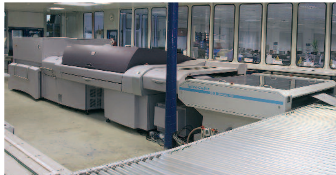
Die digitale Druckformherstellung mit dem Großformat-Thermoplatzenbelichter ist ein vollständig automatisierter Prozess – bis hin zum Einbrennen sämtlicher Druckplatten.
